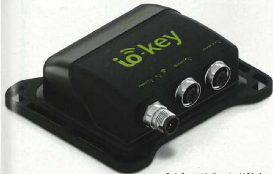
Der io-Key nutzt das Narrowband-IoT-Funknetz zur Datenübertragung. Alternativ weicht er auf den 2G-Standard aus.
